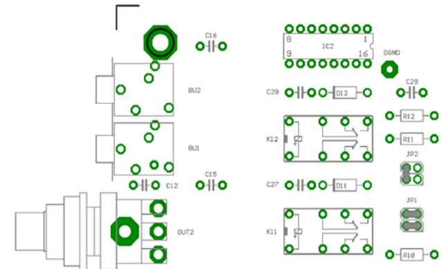
Sollten 2 Spannungsausgänge oder 2 potentialfreie Kontakte nicht ausreichen, so können die Remotebuchsen umkonfiguriert werden. Da die untere Platine, auf der sich der rechte Kanal befindet unzugänglich ist, beschränkt sich eine Änderung der Remotebuchsenkonfiguration auf die obere Platine.
